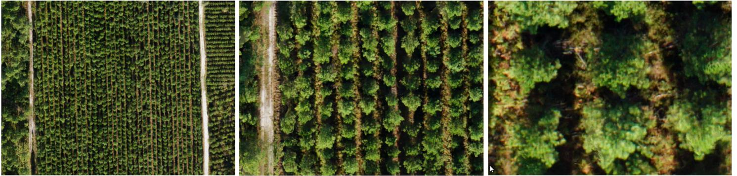
Le survol d'acquisition s'est déroulé durant l'été 2018 à une hauteur de 80 mètres sol. Le jeu d'essai est constitué d'un peuplement de pins maritimes, planté dans les années 2000. Ce vol de 10 minutes a permis de collecter 14 millions de points en 3 dimensions et 300 vues photographiques de la parcelle, qui seront assemblées pour produire une orthophoto.
